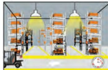
Une fois le temps de maintien écoulé, le capteur atténue la lumière à un niveau de lumière faible si aucun nouveau mouvement n'est détecté.
