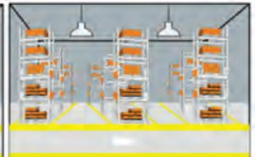
Une fois la période de veille écoulée, le capteur éteint la lumière si aucun mouvement n'est détecté dans la zone de détection.
